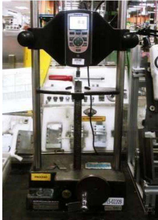
Ilustración 35.-Dinamómetro digital
