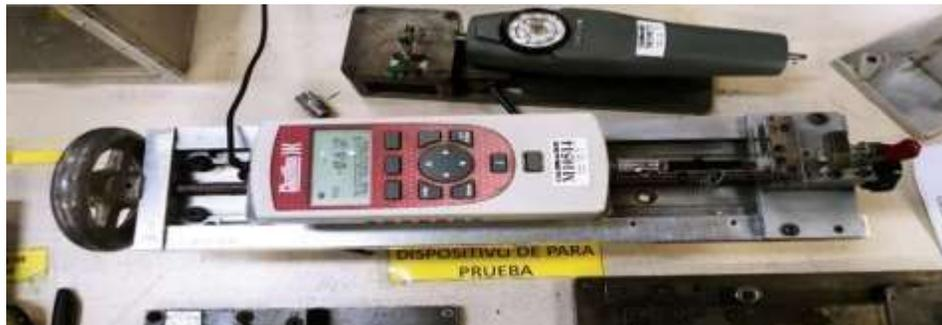
*Ilustración 38.-Dinamómetro para verificar la resistencia de la soldadura del compensador*
